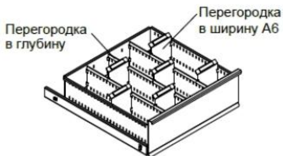
3xКД-516/536 Перегородка в глубину +4xКД-516/536 Перегородка в ширину СD (четыре ячейки с шириной 115 мм)
